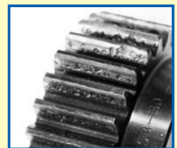
由于齿面强度不足而造成的磨损例
